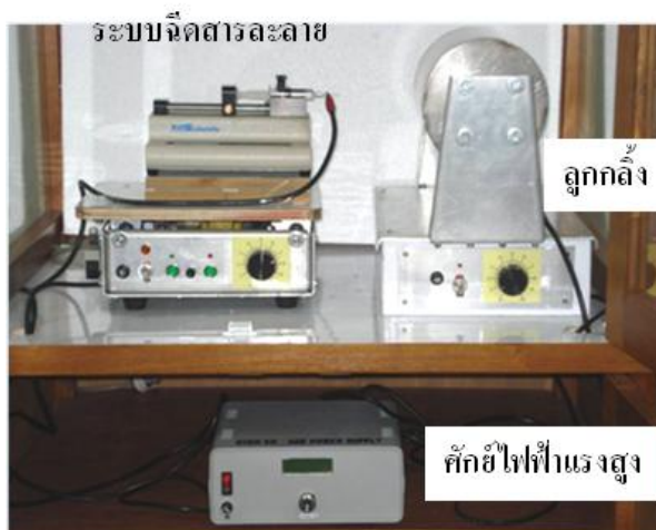
รูปที่ 1 เครื่องปั่นเส้นใยนาโนด้วยเทคนิคปั่นเส้นใยไฟฟ้าสถิต
