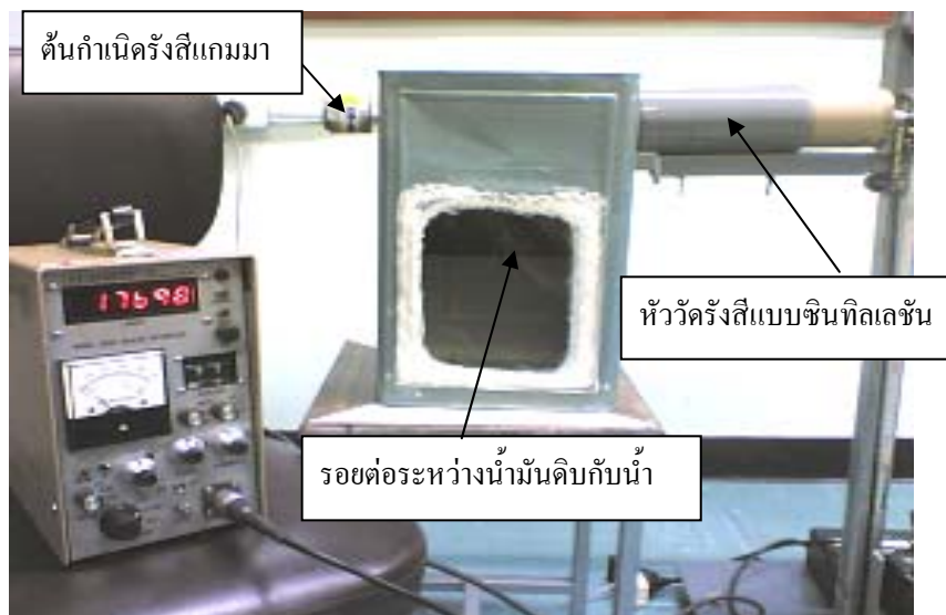
รูปที่ 1 ภาพระบบการตรวจหารอยต่อระหว่างน้ำมันดิบกับน้ำในห้องปฏิบัติการ โดยใช้เทคนิคการส่งผ่านรังสีแกมมา
