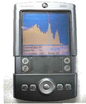
รูปที่ 8 ภาพแสดงสเปกตรัมพลังงาน ของ Co-60
