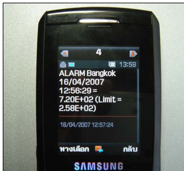
รูปที่ 6 ภาพแสดงผลการรับข้อความสั้นที่เป็นจำนวนนับรังสีแกมมาเกินกำหนดบนโทรศัพท์เคลื่อนที่ของผู้รับผิดชอบในการเฝ้าระวัง
