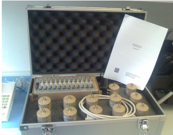
รูปที่ 1 เครื่องวัดรังสีของบริษัท Ludlum รุ่น 4612 พร้อมหัววัดรังสี NaI (Tl)
