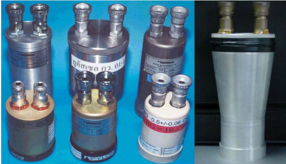
รูปที่ 1 หัววัดลูทิสเซลล์ แบบต่างๆ ที่ซื้อจากต่างประเทศ และขวามือสุดคือแบบที่ประดิษฐ์
