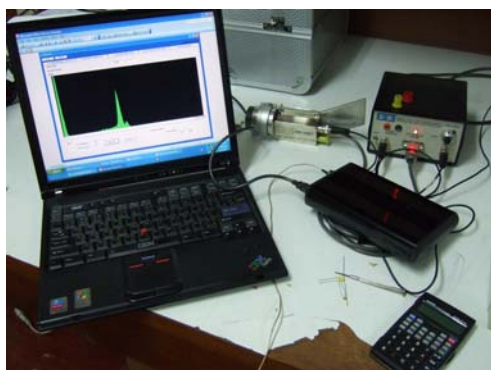
รูปที่ 8 การจัดอุปกรณ์วิเคราะห์สเปกตรัมรังสีเอกซ์
